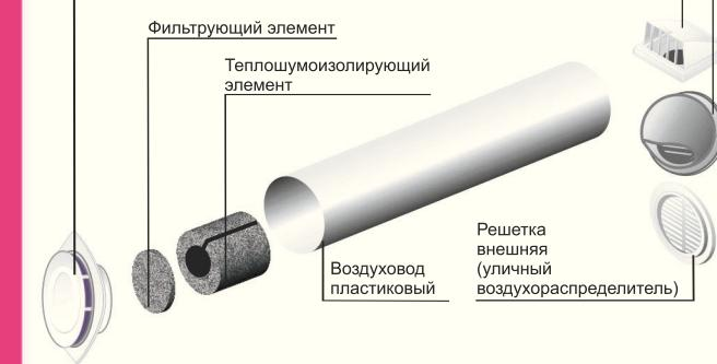
Внешние вентиляционные решетки произведены из ASA-пластика или алюминия, решетки для забора воздуха изготовлены из ASA-пластика или нержавеющей стали.
