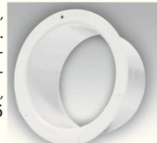
Серия СКЦ. Обратный клапан с подпружинными лопастями. Крепление при помощи хомутов. Материал: корпус - оцинкованная сталь, лопатки - алюминий. Внутри корпуса установлено демпферное уплотнительное кольцо. Размерный ряд: 100СКЦ ( $\varnothing$ 100 мм), 125СКЦ ( $\varnothing$ 125 мм), 150СКЦ ( $\varnothing$ 150мм), 160СКЦ ( $\varnothing$ 160мм), 200СКЦ ( $\varnothing$ 200мм), 250СКЦ ( $\varnothing$ 250мм), 315СКЦ ( $\varnothing$ 315мм).
