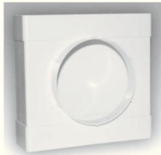
Серия Ф. Фланцы пластмассовые используются для монтажа круглых воздуховодов. Размерный ряд по диаметру канала: 10Ф ( $\varnothing$ 100мм), 12,5Ф ( $\varnothing$ 125мм), 16Ф ( $\varnothing$ 160мм), 20Ф ( $\varnothing$ 200мм).
