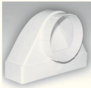
Серия Ф. Накладка торцевая с фланцем служит для монтажа круглых воздуховодов и оформления входного отверстия вентиляционной шахты. Размерный ряд: 1111Ф10 ( $\varnothing$ 100, 113x113мм), 1616Ф12,5 ( $\varnothing$ 125, 164x164мм), 1421Ф12,5 ( $\varnothing$ 125, 139x209мм).
