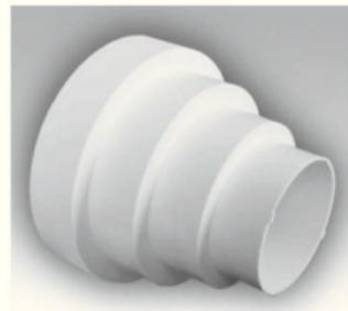
Серия ПУ. Переходники эксцентриковые универсальные предназначены для монтажа воздуховодов ВП разного диаметра. Возможные варианты: 80, 100, 120, 125, 150, 160 мм. Ненужная часть отрезается.
