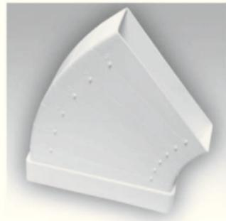
Серия КВП. Колено плоское вертикальное 90°. Служит для соединения прямоугольных воздуховодов в вертикальной плоскости. Размерный ряд по сечению канала: 612КВП ( $60 \times 120$ мм), 620КВП ( $60 \times 204$ мм).
