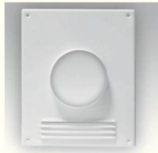
Серия ПТМ. Торцевые площадки изготовлены из стали и покрыты полимерной эмалью. Предназначены для крепления круглых воздуховодов к каналу дымохода от газового оборудования различных типов. Размерный ряд по диаметру канала: 80ПТМ, 90ПТМ, 100ПТМ, 110ПТМ, 115ПТМ, 120ПТМ, 125ПТМ, 130ПТМ, 135ПТМ, 140ПТМ, 150ПТМ, 160ПТМ.
